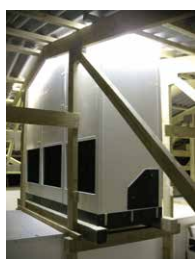
Prinzip der Stalllüftung mit integrierter Wärmerückgewinnung
